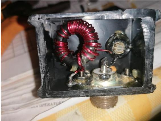
**Funziona bene in 10, 20 e 40 metri, senza bisogno di accordatore come si può controllare dal display del Ft817. Al quadripite, costruito da Evaristo IK2YXQ, attacco una canna da pesca di 8 metri e l'end-fed la faccio scendere fino a un metro da terra. Se il balun è collocato più basso di un metro non funziona più bene.**
